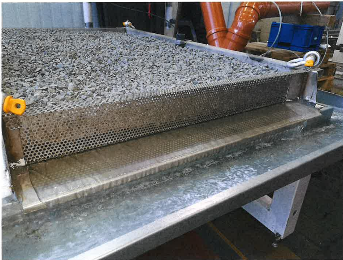
Abb. 3: Prüfkörper während der Versuchsdurchführung mit Blick auf die Wassersammelrinne, die zur Beprobung führt.
