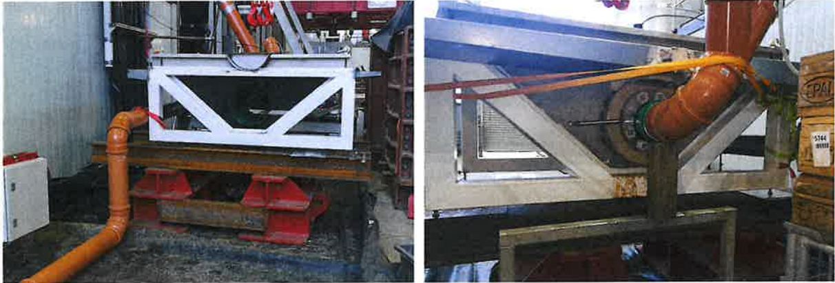
Abb. 1: Der Prüfrahmen im Versuchsstand. Links: Blick auf das Ende. Rechts: Zulauf in das FiltraSed-Modul
